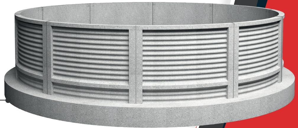
La unión entre placas se realiza a través de tornillos galvanizados. Para asegurar que no haya pérdidas entre la unión de placas se colocan dos tiras de membrana pegadas con pintura asfáltica.
