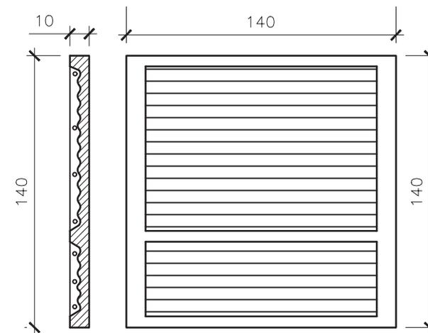
CORTE Y VISTA LOSA PREMOLDEADA
